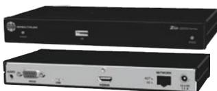
Компактные мультивьюеры серии Zio D2000 позволяют декодировать и просматривать сразу несколько потоков с разрешением до 2K на одном дисплее. Для облегчения установки все модели поддерживают технологию PoE (питание по сети Ethernet).
