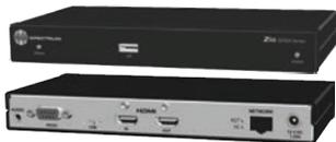
Компактные энкодеры Zio S2000 принимают от источников сигналы с разрешением до 4K через HDMI-интерфейс и имеют мониторный HDMI выход. Для облегчения установки все модели поддерживают технологию PoE (питание по сети Ethernet).
